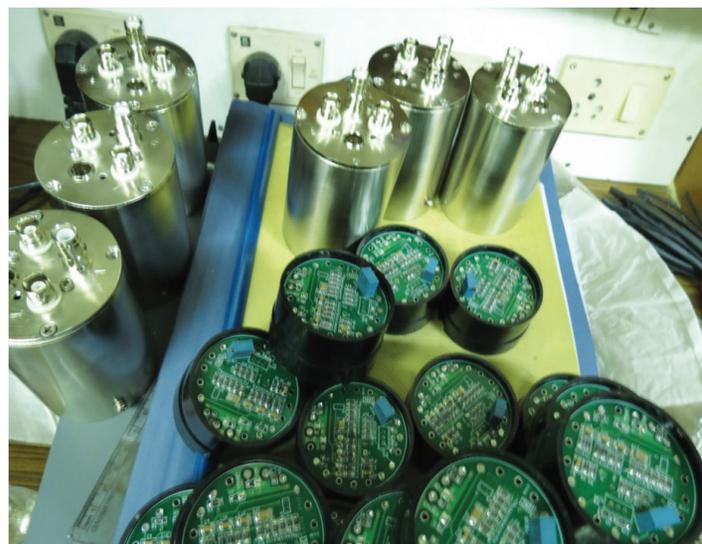
**Fig. 4 : PMT Bases**
